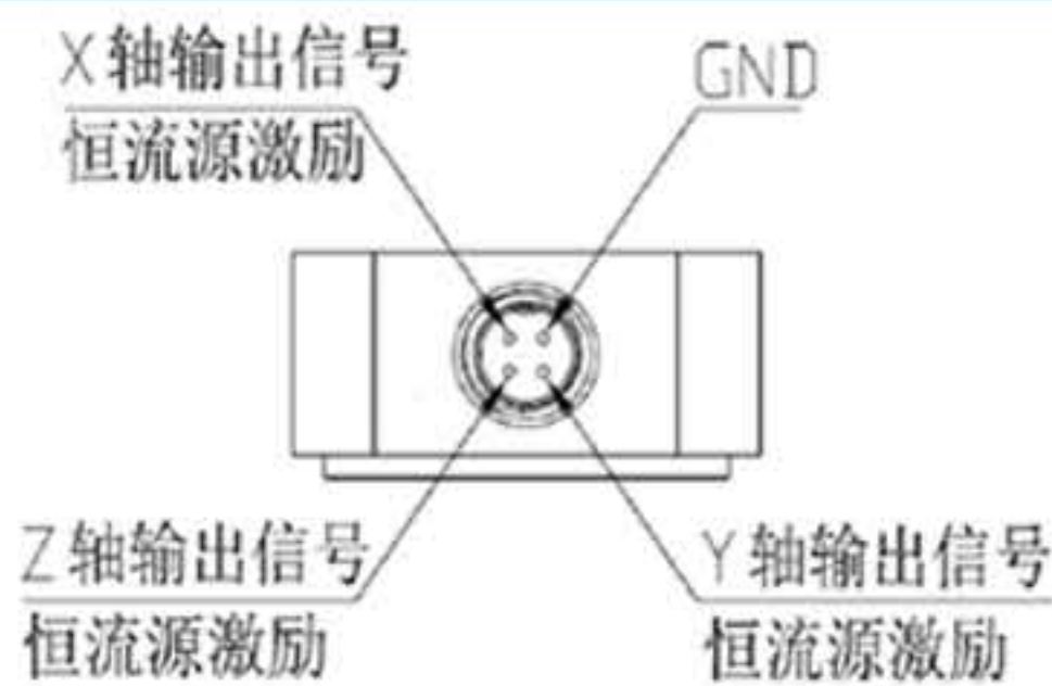
四芯连接器连接端子定义
